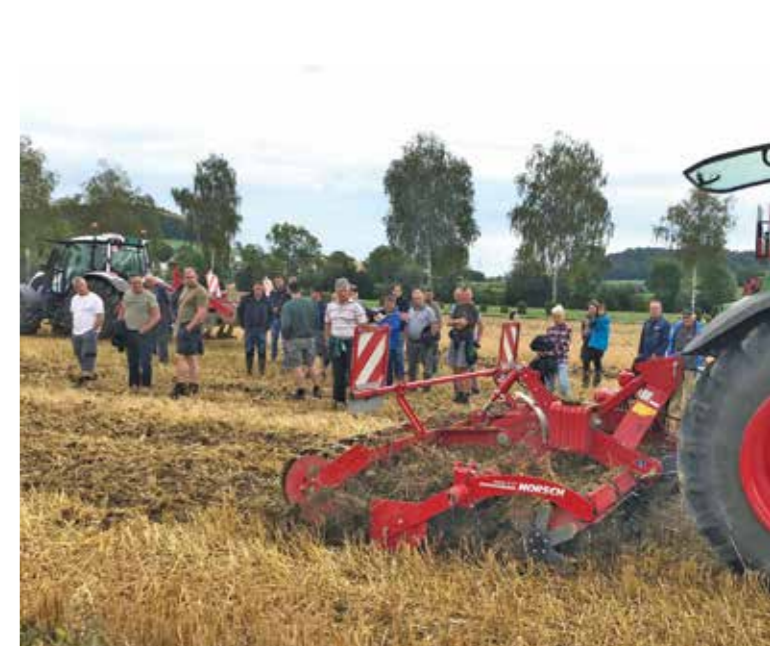
Die Kurzscheibenegge kann hoch oder tief eingestellt werden, auch in Kombination mit der Frontmesserwalze, um bei hoher Fahrgeschwindigkeit einen guten Einarbeitungseffekt zu erzielen.
